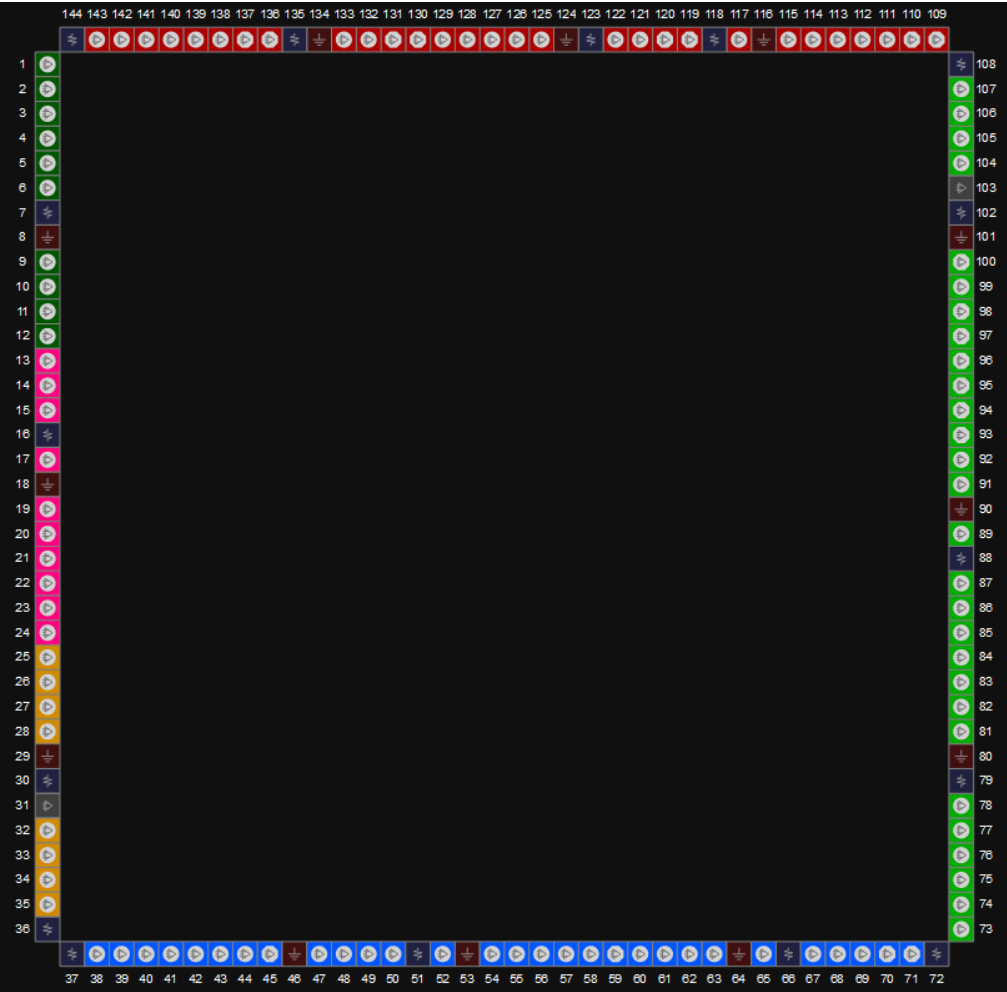
图 3-20 GW1N-2 器件 LQ144 封装管脚分布示意图（LV 版本,顶视图）
