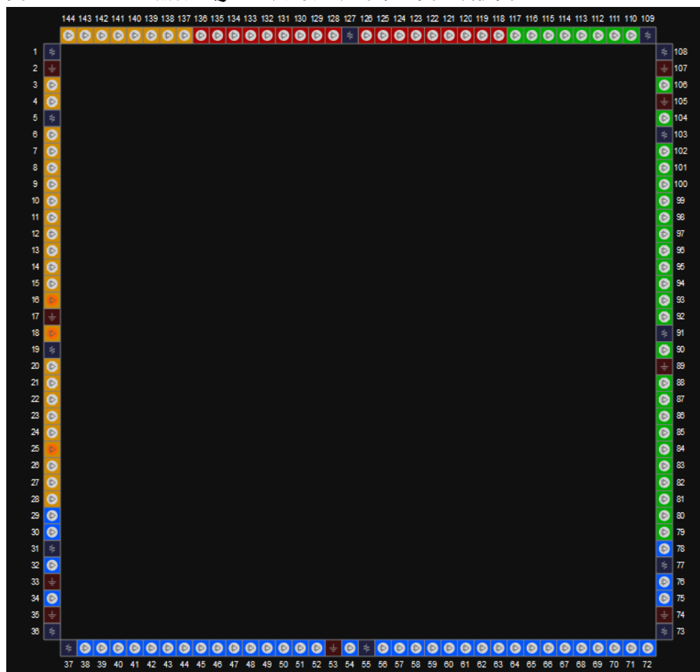
图 3-64 GW1N-9 器件 LQ144 封装管脚分布示意图 (顶视图)
