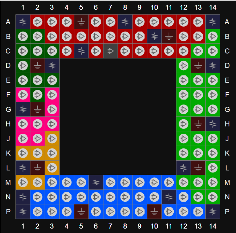
图 3-11 GW1N-2 器件 MG132X 封装管脚分布示意图（UV 版本,顶视图）
