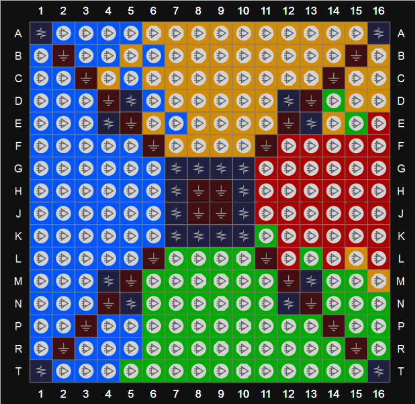
图 3-71 GW1N-9 器件 PG256 封装管脚分布示意图（顶视图）
