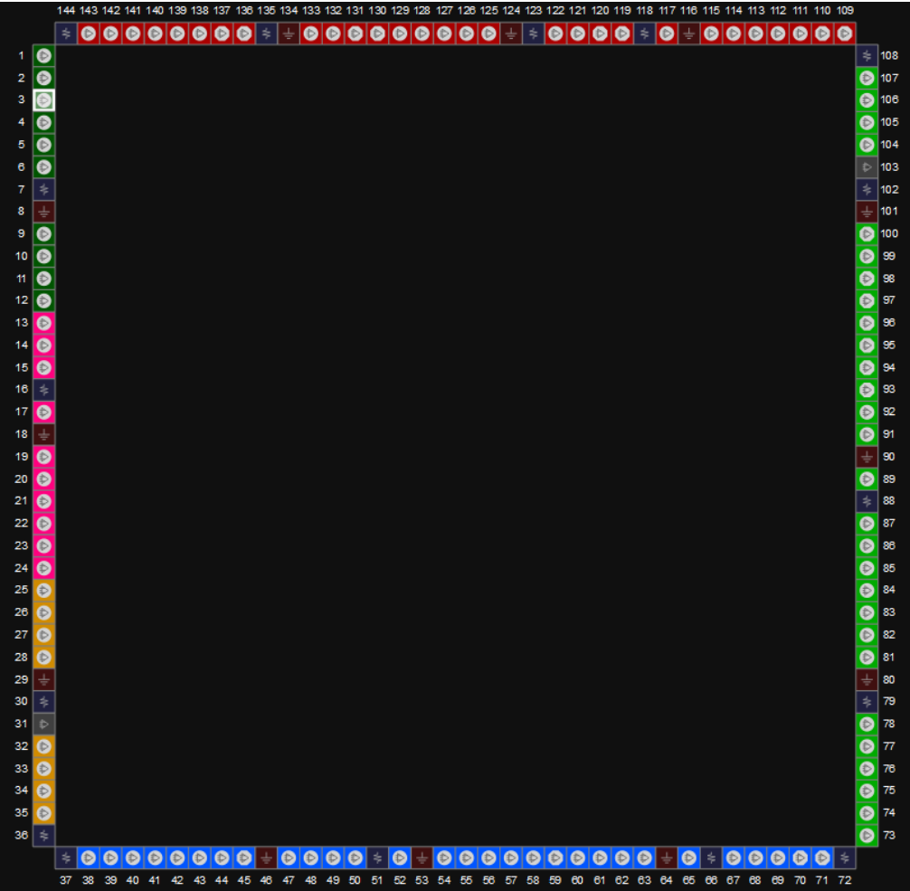
图 3-17 GW1N-2 器件 LQ144X 封装管脚分布示意图（UV 版本,顶视图）
